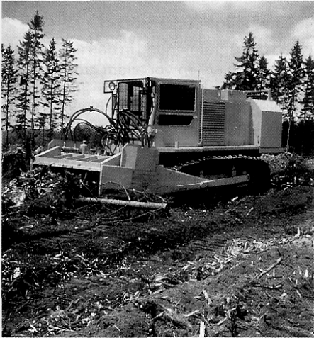
Abb. 3 (links): Die Kronfräse, fachgerecht eingesetzt, erfüllt die Forderungen, die an die Melioration der Humusaufgabe gestellt werden, in idealer Weise. In vielen Fällen ist sie Wegbereiter für das Ahrweiler Meliorationsverfahren.
